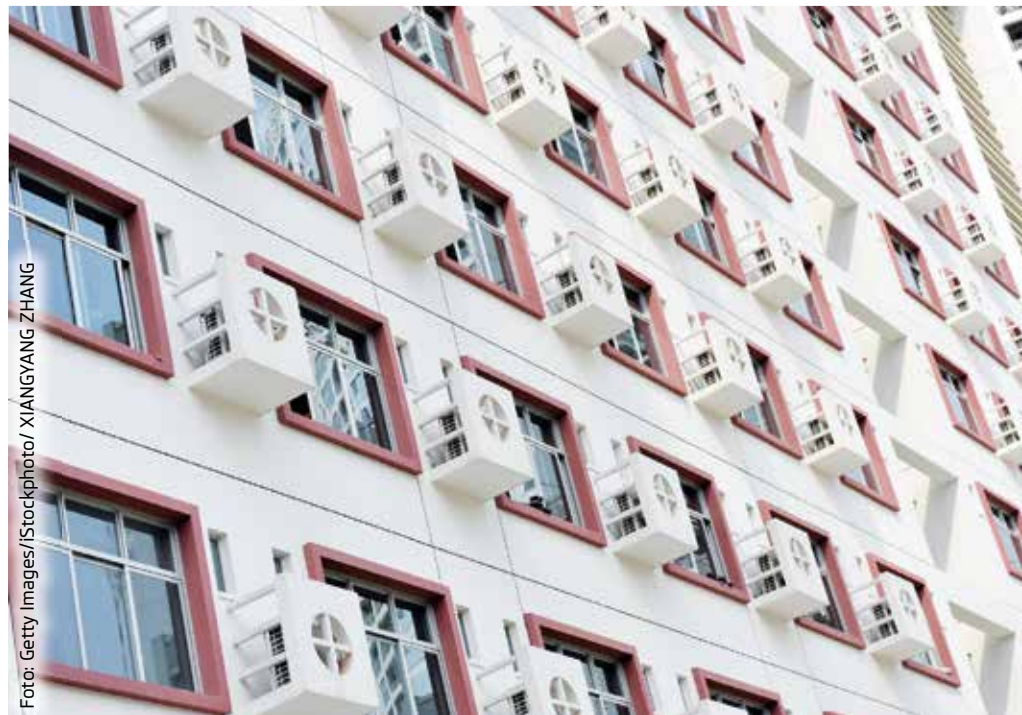
Abbildung 2: Split-Geräte können Räume schnell abkühlen, überwachen aber keine Parameter wie Luftqualität und Luftfeuchte. Sie schaffen daher kein echtes Wohlfühlklima. Sie werden daher in erster Linie für den Hausgebrauch vorgesehen.
