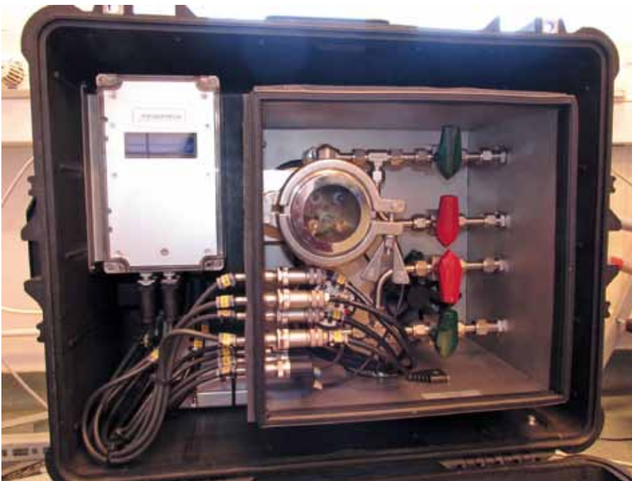
Abbildung 1: Mobile Messeinheit zur Erfassung von pH-Wert, Redoxpotenzial, Leitfähigkeit, Sauerstoffgehalt und Temperatur als korrosionsrelevante Parameter Foto: Leuphana
