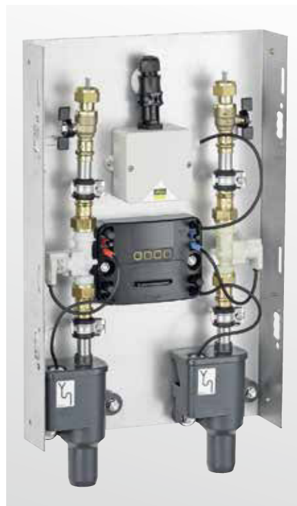
Abbildung 5: In den Sanitäranlagen der APASSIONATA WORLD hält an den entferntesten Trinkwasserverbrauchern eine Viega Spülstation mit Hygiene+ Funktion den regelmäßigen Wasserwechsel aufrecht, wenn Nutzungsunterbrechungen erkannt werden.
