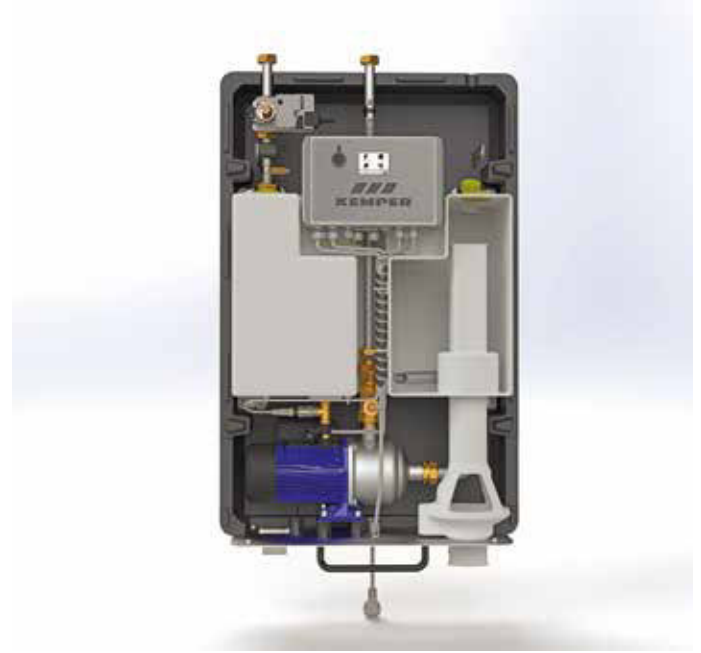
Abbildung 6: FK-5 Sicherheitstrennstation – Freier Auslauf Typ AB; Schnitt des Behälters mit Darstellung des innenliegenden Überlaufes
