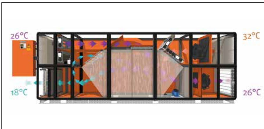
Abbildung 7: RLT-Anlage mit Taupunktkühlung und Nacherhitzer
