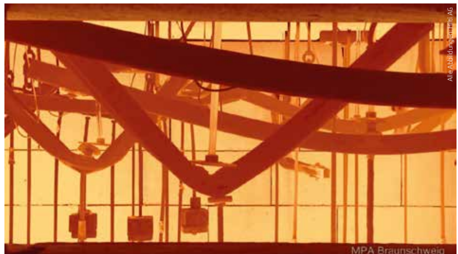
Abbildung 1: Verformungen von Montageschienen unter erhöhten Temperaturen
