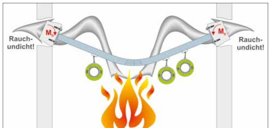
Abbildung 5: Rauchundichtigkeit an Wandbefestigungen ausschließen
