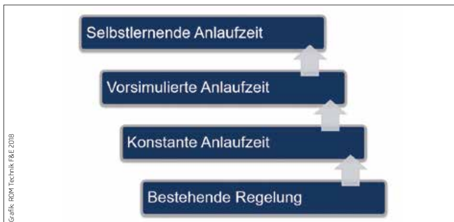
Abbildung 4: Struktur der Integration der Anlaufzeitoptimierung: Hierarchie- bzw. Rückfallebenen für den sicheren Betrieb
