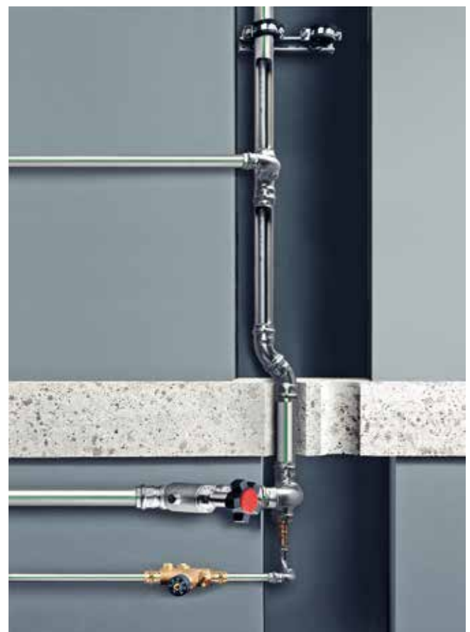
Die Vorteile der „Smartloop“-Inlinertechnik von Viega sind vielfältig: Durch den im Rohr geführten Rücklauf reduziert sich der Platzbedarf im Schacht. In einer Trinkwasser warm-Zirkulation wird so außerdem die Wärmeabstrahlung verringert. Diese Technik ist aber ebenso für eine Trinkwasser kalt-Zirkulation mit aktiver Kühlung ideal.
