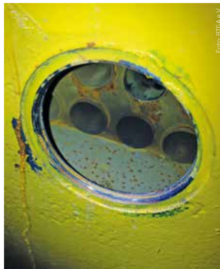
Abbildung 3: wasserseitige Anschlüsse der ersten AKA-Anlagen mit zu geringen Wandstärken
