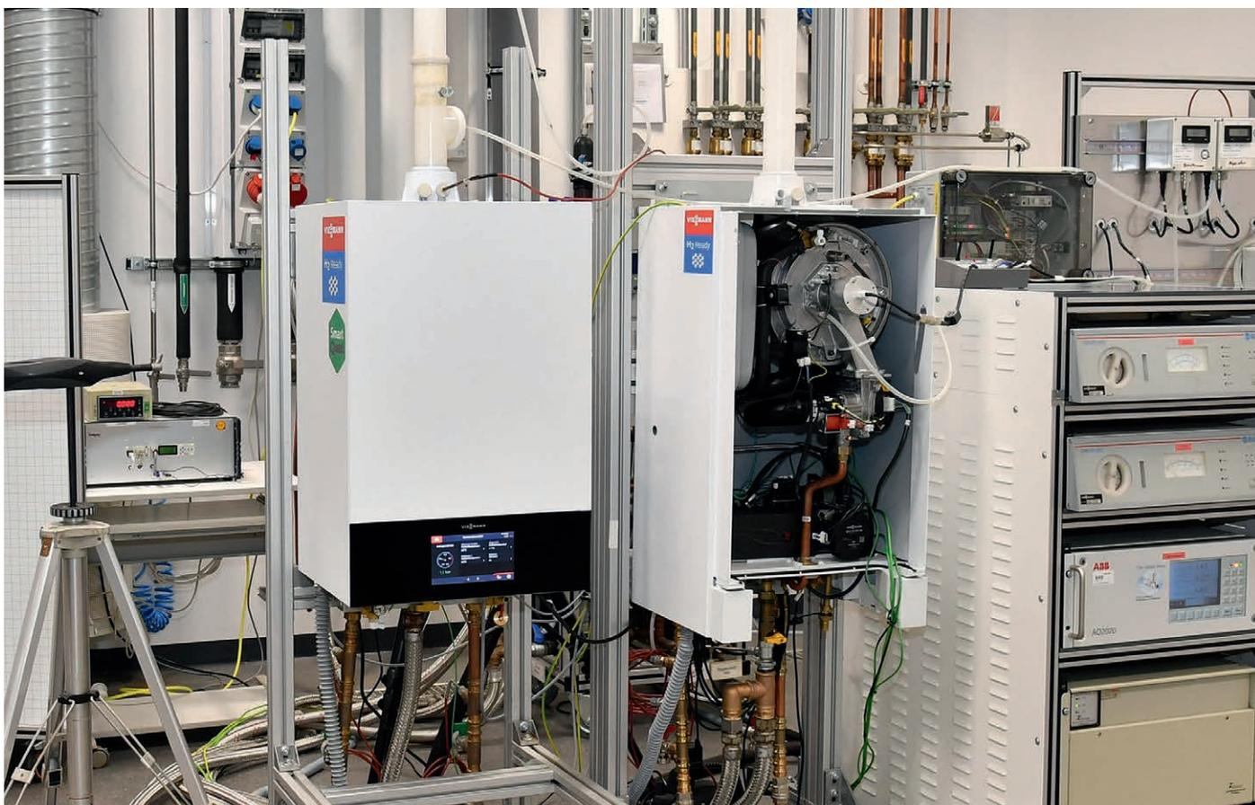
Abbildung 1: Prüfstand im Jahr 2020 mit Prototypen für 100-Prozent-H<sub>2</sub>-ready-Gasbrennwertgeräte
