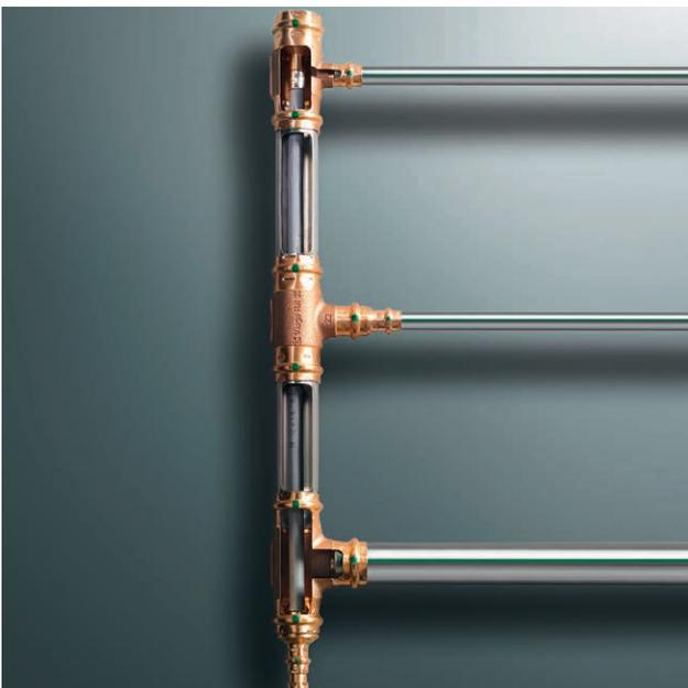
Abbildung 5: Bei einer Inliner-Zirkulation verläuft der Rücklauf im Steigrohr. Das verringert die Verluste durch Wärmeabstrahlung und ist ein weiterer Mosaikstein für eine energieeffizientere Warmwasserbereitung.
