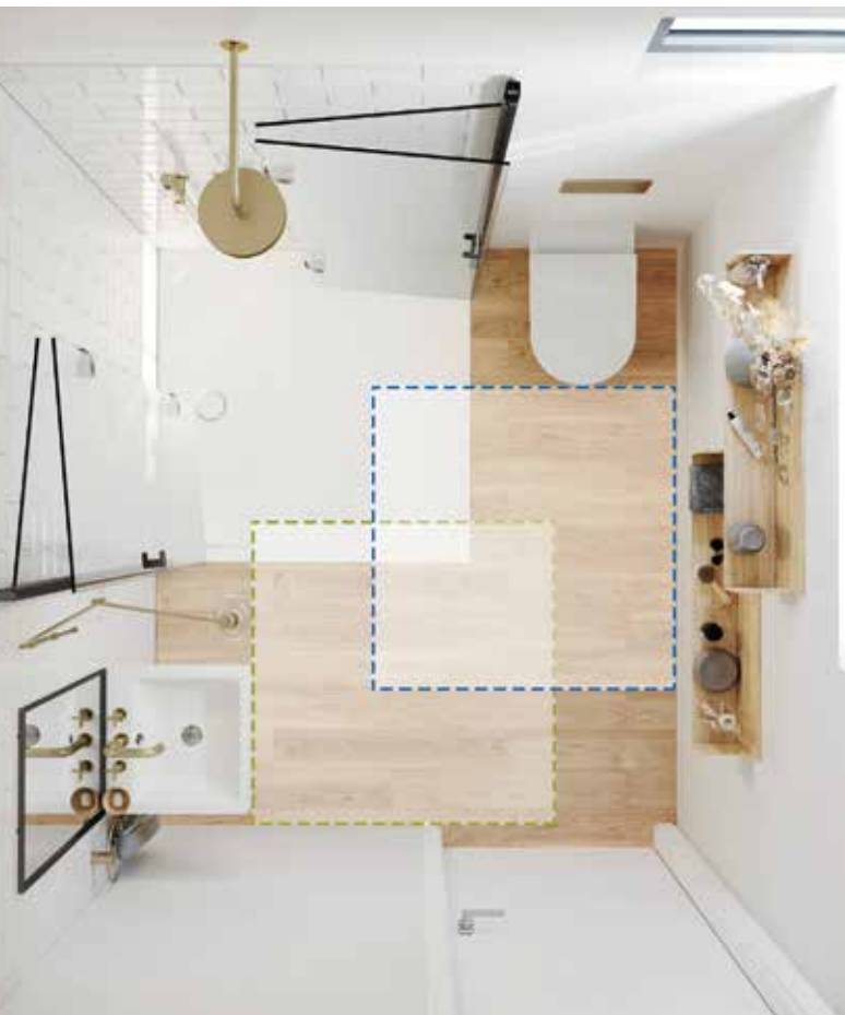
Abbildung 3: Die DIN 18040-2 lässt im Bestand zu, Bewegungsflächen planerisch zu überlagern.
