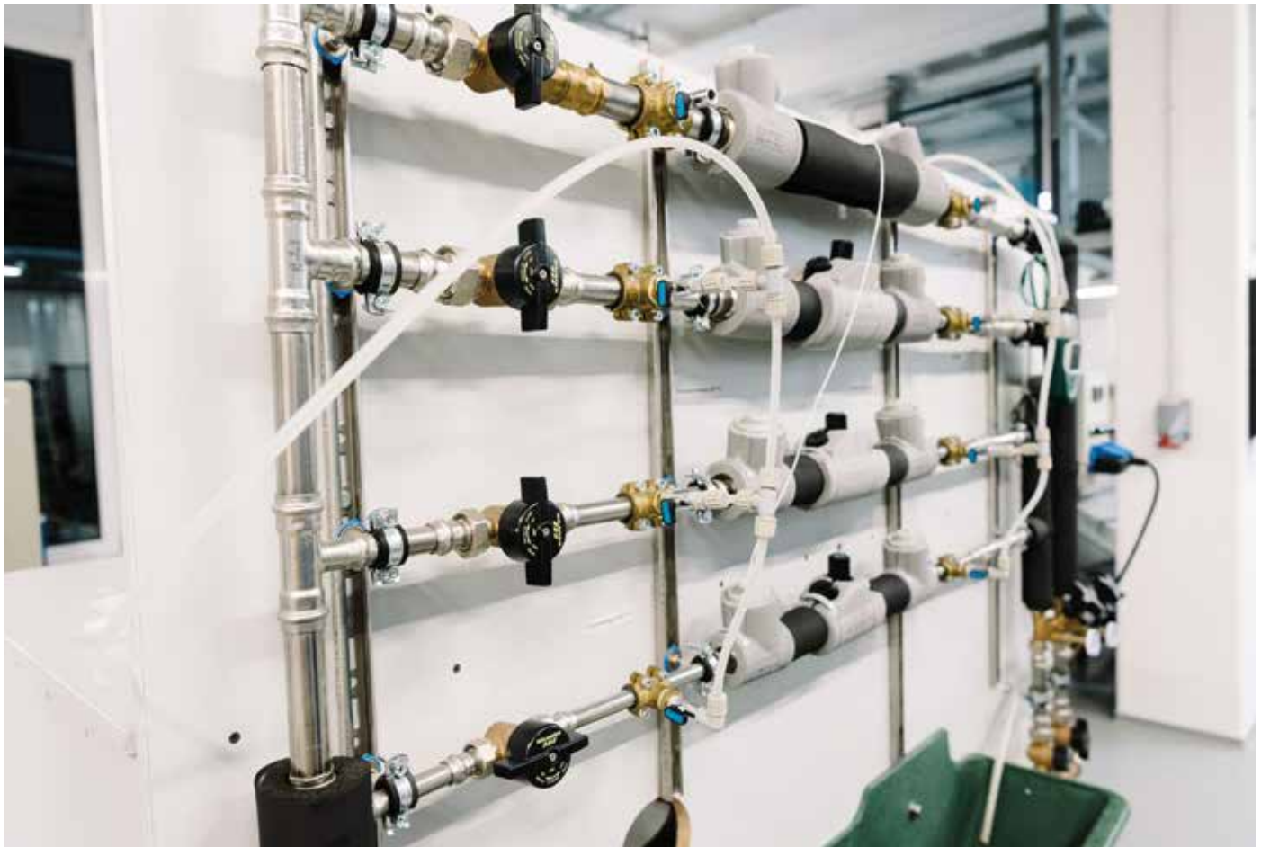
Abbildung 10: Prüfstand für geregelte Zirkulationsventile (FH Münster – Fachbereich EGU)
